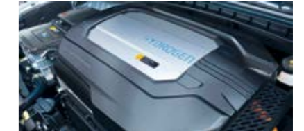
La pile à combustible fonctionne en faisant circuler l'hydrogène et l'air à travers une unité de piles à combustible.
