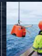
La société allemande K.U.M. Offshore a fourni les huit sismographes NAMMU de 300 kg chacun pour surveiller l'activité sismique à la plateforme de Nini, exploitée par INEOS
