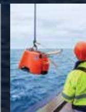
Das deutsche Unternehmen K.U.M. Offshore hat acht 300 kg schwere NAMMU-Seismometer zur Überwachung der seismischen Aktivität an der Nini-Plattform von INEOS geliefert
