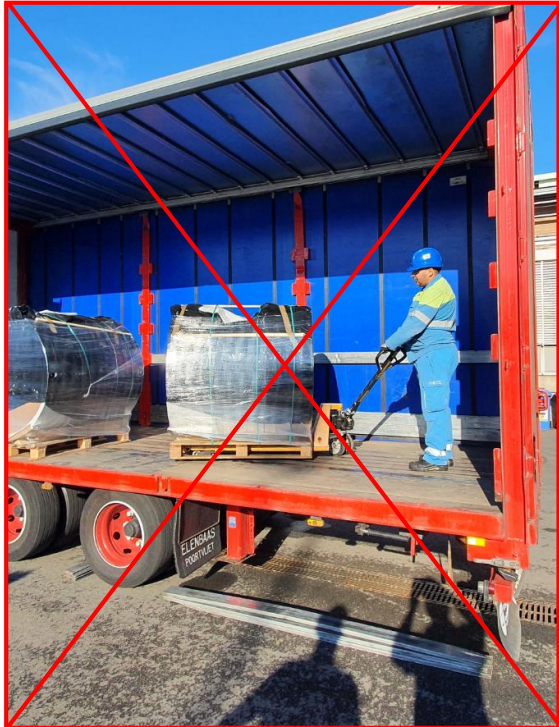
Open zijkant: gebruik transpallet is verboden
