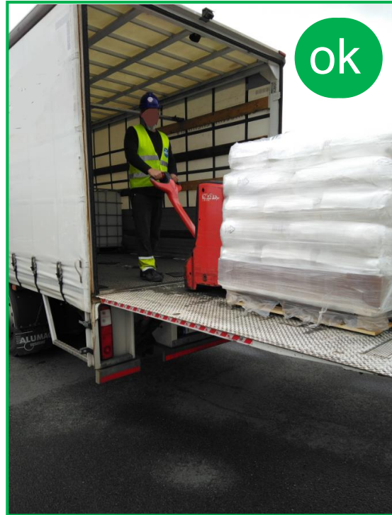
Laadbrug: correct gebruik transpallet
