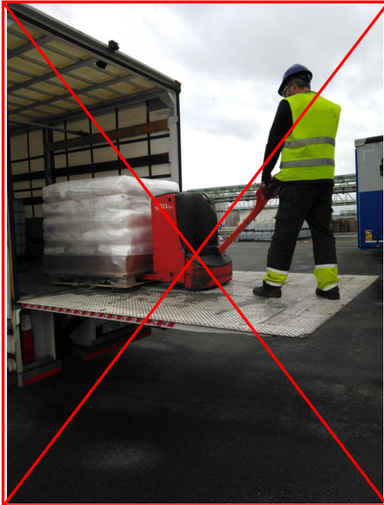
Laadbrug: fout gebruik transpallet
