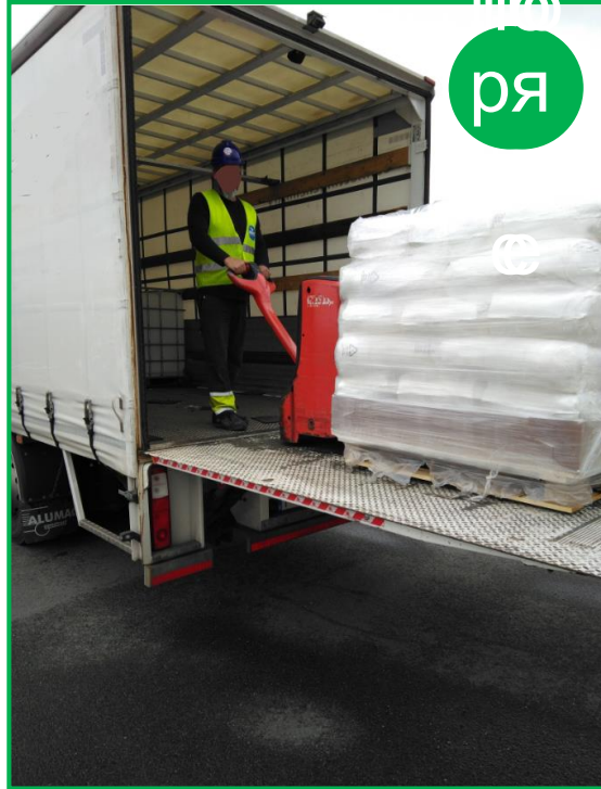
Гидроборт: правильное использование тележки для поддонов
