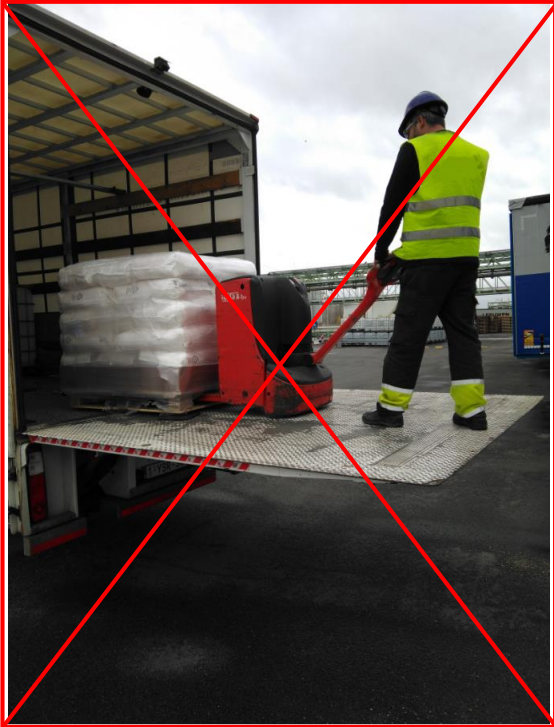
Гидроборт: неправильное использование тележки для поддонов
